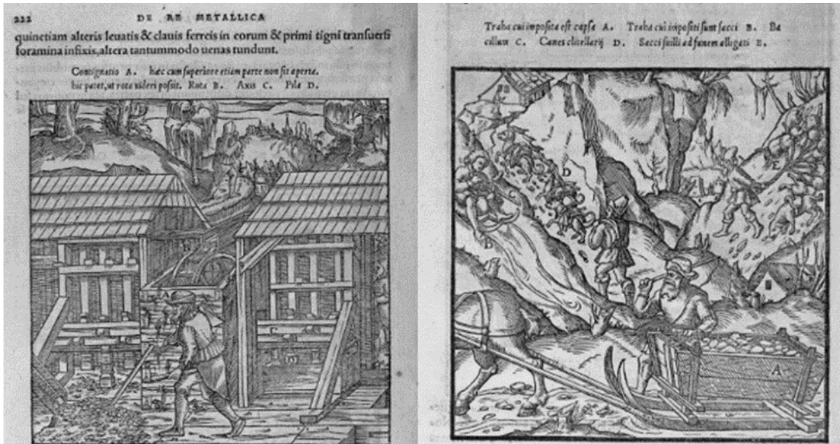
Abbildung 90: Ein Pochwerk und ein Ziehschlitten, aus Georg Agricola, De re metallica , 1561
